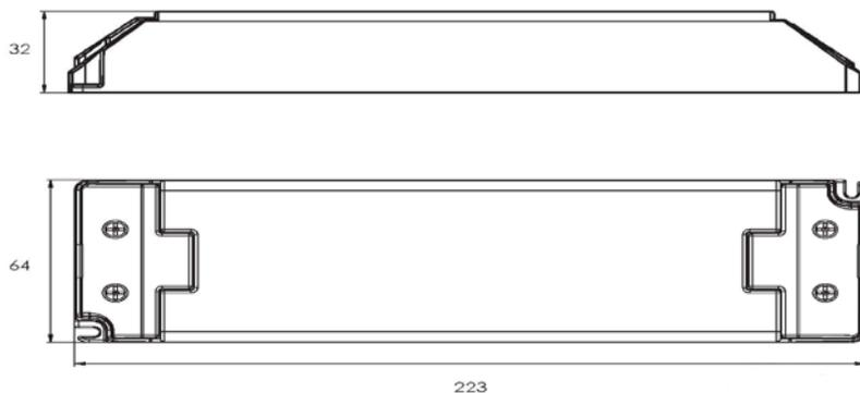
·Die maximale Länge des Sekundärkabels zur LED-Leuchte sollte 4 m nicht überschreiten, um die EMV-Standards zu erfüllen.
